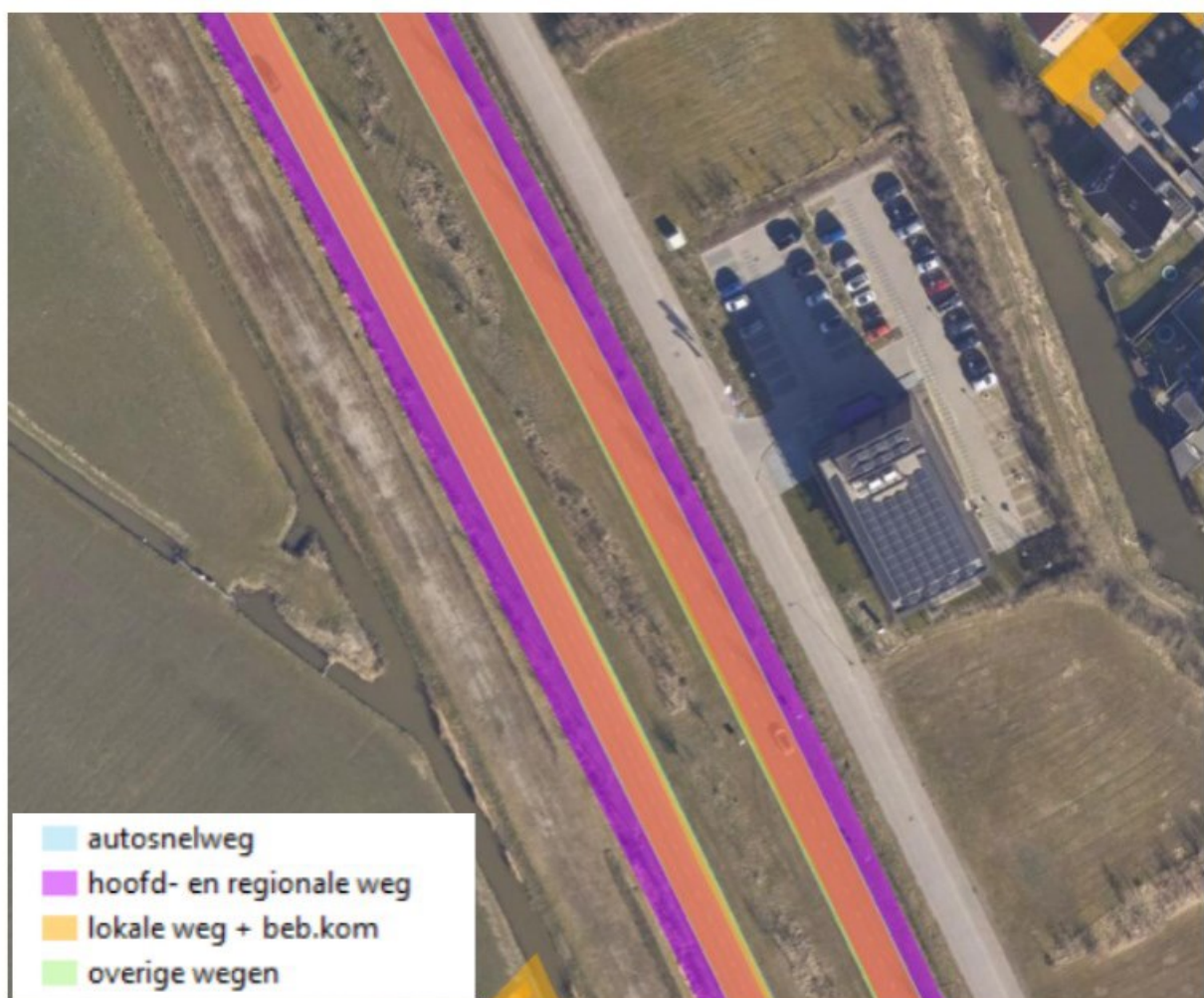
Figuur 3 Vergelijking BGT wegen met Top10NL waarbij BGT boven op Top10NL is geprojecteerd. Het oranje gedeelte is waar de weg overlapt met Top10NL en BGT. Het Paarse deel is het gedeelte wat met de top10NL onnauwkeuriger is afgebakend dan de BGT.
